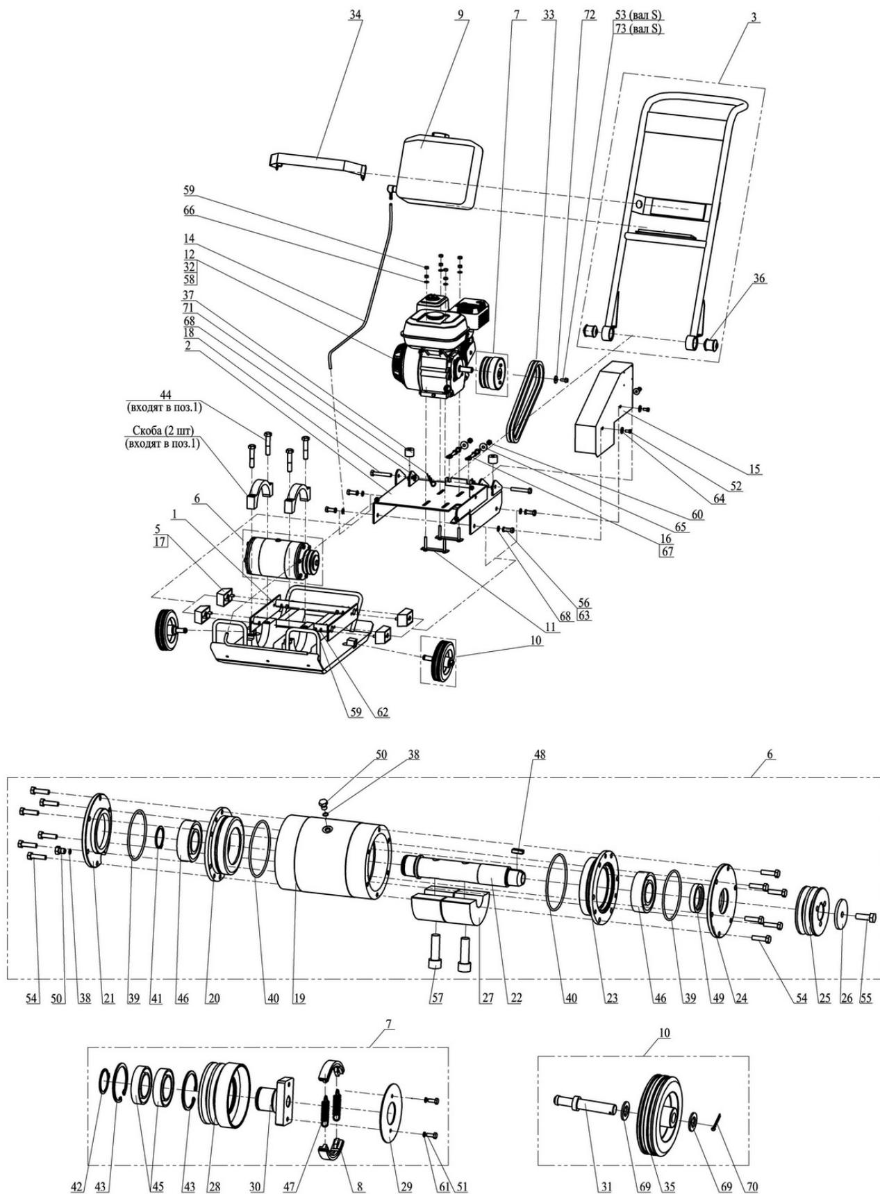
Рисунок 8 – Компоновка виброплиты
