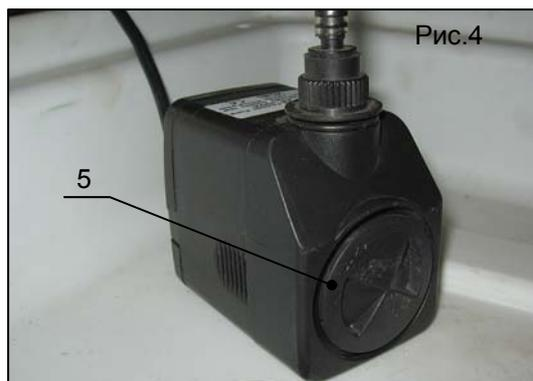
5. Всегда держите чистым пространство вокруг всасывающего сопла. Периодически проверяйте и очищайте от осадка, и различных загрязнений всасывающее сопло насоса.
