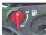
Рис 4.4: Выключение топливного крана
